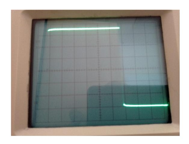
П.7.2.4. Данные по измерению длительности фронта импульса: измеряете по осциллограмме  ${\it l}_X$  ; коэффициент развертки =0.2 мкс/дел, множитель развертки  ${\it M}=0.1$ . Оценить погрешность измерения, записать исправленный результат измерения.
